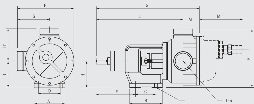
Peso della pompa ad asse nudo - *pump weight free shaft* ~38 kg
