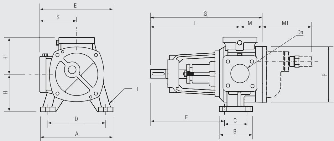
Peso della pompa ad asse nudo - *pump weight free shaft* ~38 kg
