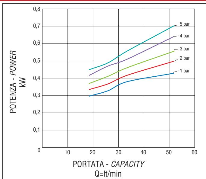
Pompa tipo NE20 - NE 20 type pump
