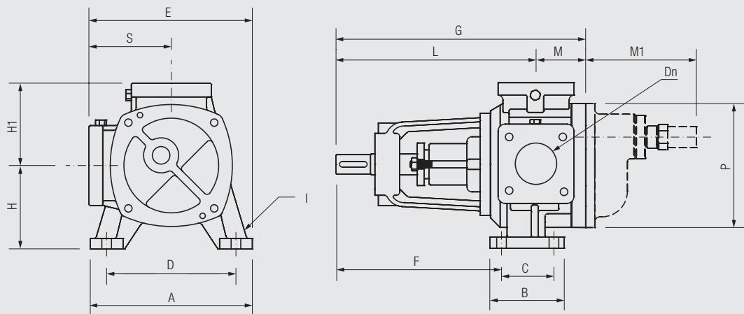
Peso della pompa ad asse nudo - *pump weight free shaft* ~27 kg
