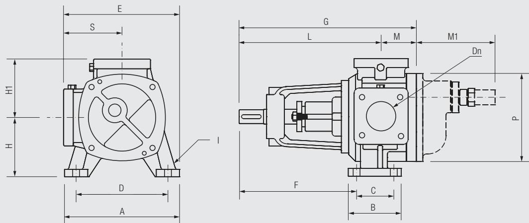
Peso della pompa E100 ad asse nudo - E100 pump weight free shaft ~180 kg
